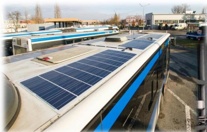
Baterie fotowoltaiczne na dachu autobusu
