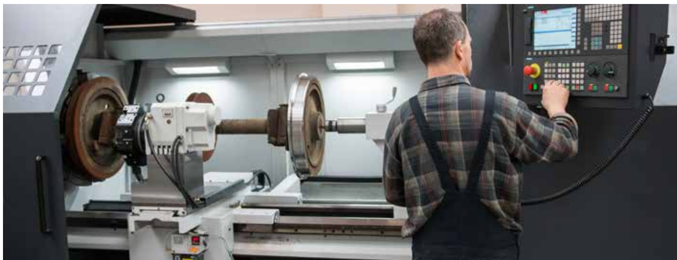
Nowa tokarka umożliwia obróbkę całych zestawów kołowych
