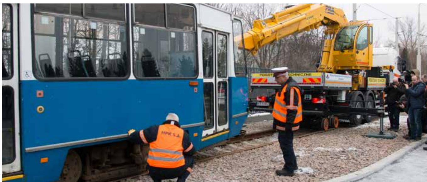
Pojazd może się poruszać zarówno po jezdni, jak i torowisku tramwajowym
